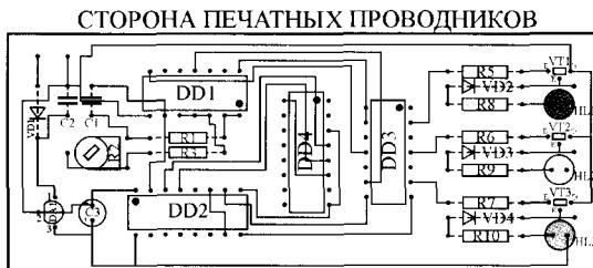
**Рис.3. Светодинамическое устройство для трех светодиодных гирлянд. Вариант 1. Топология печатной платы**
